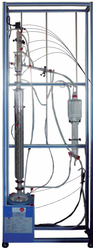
① Unit: UDDC. Batch Distillation Unit
