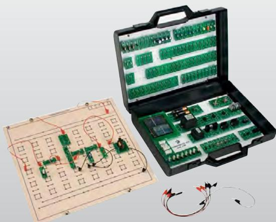
Система состоит из главной печатной схемы, снабженной отверстиями с определенным шагом, и широкого набора компонентов, запаянных в державку, которая имеет стандартные монтажные ножки для установки компонентов в главную схему. Путем сочетания нужных компонентов можно получить любой тип цепи. Питание и соединение компонентов обеспечивают тросики.
