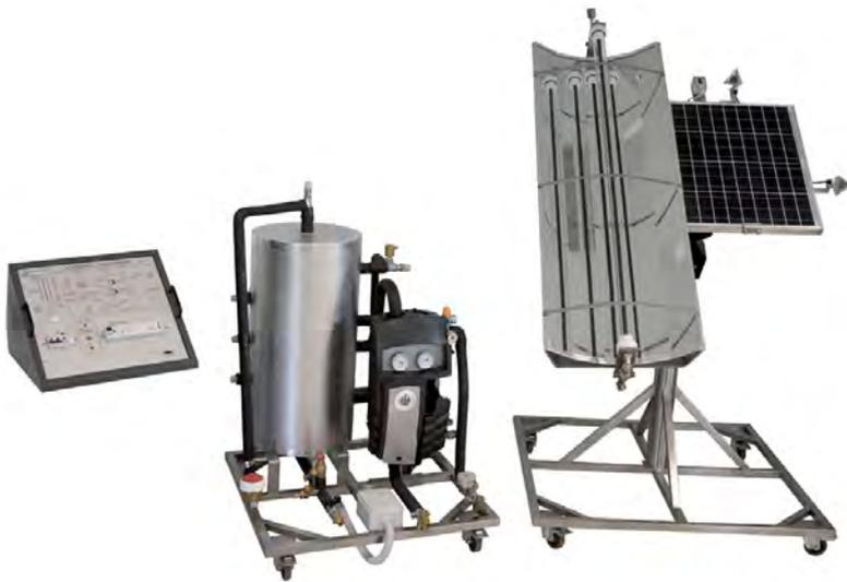
Концентратор солнечного излучения – это вакуумный коллектор, на котором тепловая мощность солнца концентрируется с помощью параболическо-цилиндрических зеркал. Зеркала ориентируются солнечным трекером для оптимизации термической производительности системы. Циркуляцию воды внутри коллектора, соединенного с бойлером, обеспечивает насос, питаемый как от солнечной энергии, так и от электросети.
