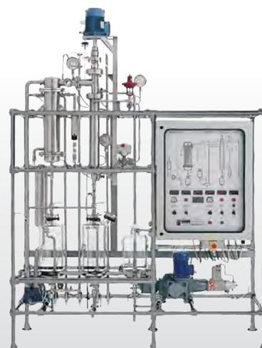
В пленочных выпарных установках с механическим смешиванием продукта, в отличие от других типов выпарных аппаратов, процесс удаления влаги происходит в пленке, перемещающейся по поверхности греющих трубок. Преимуществами пленочных выпарных установок являются:
