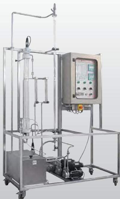
◀ Мод. WWA/EV – Опытная установка для анализа адсорбции на мокрых вертикальных поверхностях
