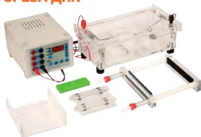
Система включает в себя электрофорезную ячейку, дно которой пропускает ультрафиолетовое излучение, для проведения горизонтального электрофореза в агарозном геле и блок питания с 4 выводами.
