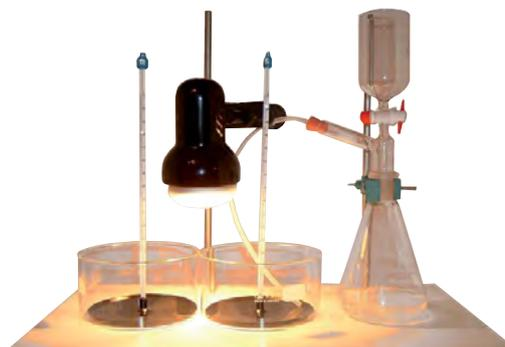
Предлагаемый эксперимент позволяет визуализацию парникового эффекта, вызываемого двуокисью углерода. В одну емкость вводится двуокись углерода, получаемая от химической реакции, что вызывает подъем температуры. Система включает в себя лампу и генератор двуокиси углерода и поставляется вместе с химическими реактивами и инструкцией.
