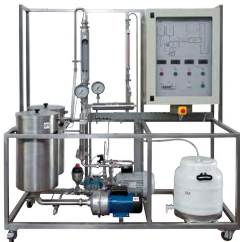
Гибкая система для анализа обратного осмоса и ультраfiltrации в широком диапазоне рабочих условий. В частности:
