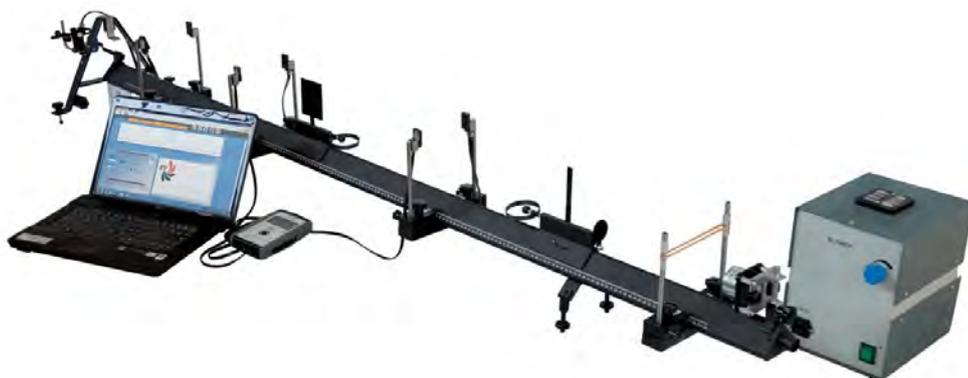
для определения постоянной свободного падения тел «g». Для изучения этого процесса можно использовать соленоид, прикрепляемый к рельсу. Высота падения тела (в данном случае, падения мяча) регулируется.
