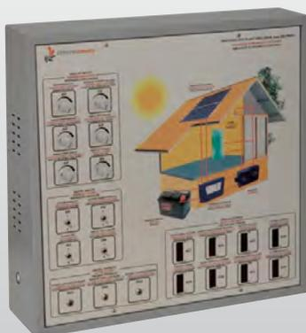
Учебный симулятор мод. SIM-PM/EV обеспечивает возможность изучения работы автономной фотоэлектрической установки (не связанной с электрической сетью). Эта установка улавливает солнечное излучение с помощью фотоэлектрической панели и преобразовывает его в электроэнергию, готовую для потребления. Регулятор напряжения зарядки аккумулятора и инвертер обеспечивают бесперебойную работу системы.
