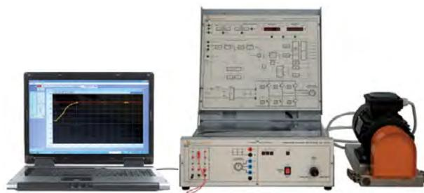
Система мод. TID1/EV обеспечивает учащимся возможность углубления теоретических и практических знаний по скалярным приводам В/Гц для трехфазных асинхронных двигателей с синусоидальным контролем вращения. Система состоит из исключительно промышленных компонентов реальных размеров.
