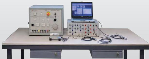
Компьютеризированная система для измерения электрических величин и проведения лабораторных испытаний на цепях электрических машин, как вращающихся, так и статических. Система включает в себя измерительный прибор мод. СЕМ-U/EV с оснасткой, питатель мод. СЕМ-E-A/EV, один ПК и лабораторный стол.
