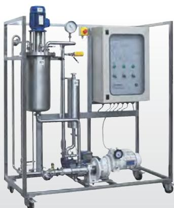
Установка деаэрации используется для удаления воздуха и других зловонных веществ, поглощаемых продуктом во время обработки. Процесс деаэрации обеспечивает получение более стабильного и однородного продукта без дефектного вкуса.
