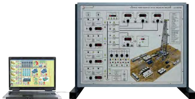
Этот симулятор используется для изучения электрических систем установок бурения нефтяных скважин. Он позволяет изучить и испытать
