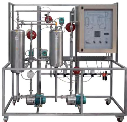
Минилаборатория спроектирована для автоматизированного одновременного регулирования расхода, уровня, температуры и давления жидкости, которое выполняется с помощью пропорционально-интегрально-дифференциального (ПИД) многоцепного регулятора.
