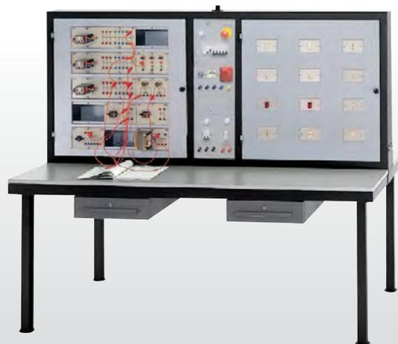
Этот рабочий стенд позволяет учащимся провести полную программу практического обучения по монтажу, выполнению кабельных соединений и испытанию осветительных и сигнальных электроустановок, промышленных электрических установок и электропневматических систем. 5 взаимозаменяемых типов панелей обеспечивают возможность проведения практических занятий на реальном оборудовании по самым распространенным видам выполнения электрических соединений.
