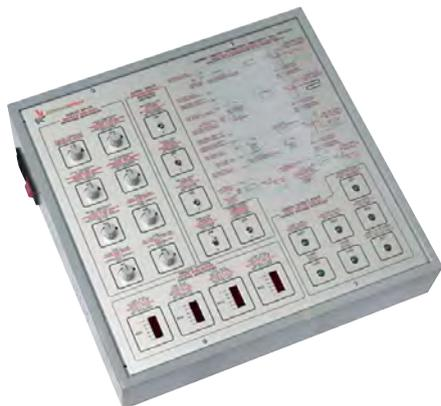
Эта аппаратура симулирует работу ряда установок распределения энергии для отопления или охлаждения жилых домов.
