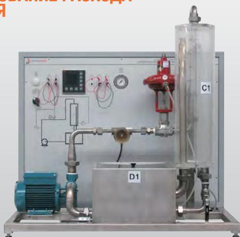
Это настольное оборудование используется для проведения разных экспериментов по контролю уровня и расхода жидкостей. Оно включает в себя замкнутую схему с накопительной емкостью, рециркуляционный насос, регулировочный клапан, датчик расхода и уровня и ПИД-регулятор.
