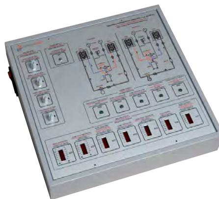
Это устройство симулирует работу домашней установки кондиционирования (Сплит-системы) с инвертером, регулирующим число оборотов компрессора в зависимости от разницы между установочным значением и действительным значением температуры окружающей среды.
