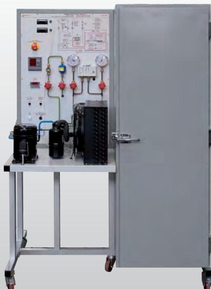
Это тренажерное оборудование спроектировано для изучения процесса охлаждения при отрицательных температурах. Оборудование включает в себя все компоненты охладительной установки промышленного типа, в том числе изолированную холодильную камеру с системой размораживания, снабженной электронным регулятором. Электрическое сопротивление обеспечивает возможность симулирования изменения температуры в холодильной камере.
