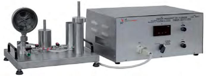
▲ Мод. TE2/EV - Оборудование для измерения и калибровки давления
