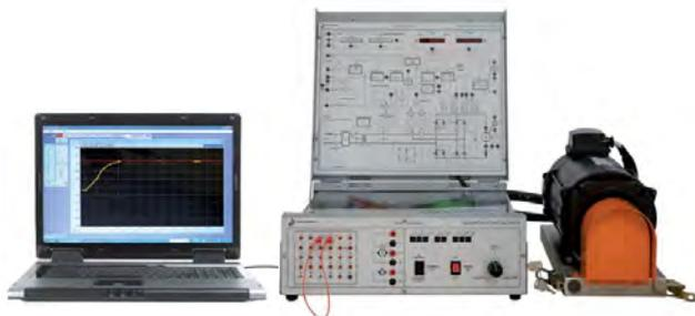
Система мод. DSD1/EV, входящая в состав лаборатории сервомеханизмов, является необходимым средством для теоретического и практического изучения всех предметов, связанных с тиристорными приводами переменного и постоянного тока и шунтовыми двигателями постоянного тока. Система состоит из исключительно промышленных компонентов реальных размеров.
